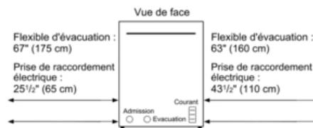
Tous les raccordements se trouvent à la face arrière de l'appareil.
